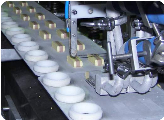
Estrusione e taglio candy bar - Candy bar extrusion and cut - Extrusion et coupe de Candy bar
