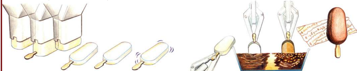
Dosaggio e taglio inserimento nello stecco Dosing and cutting insertion of the stick Dosage et coupe insertion dans le bâtonnet
